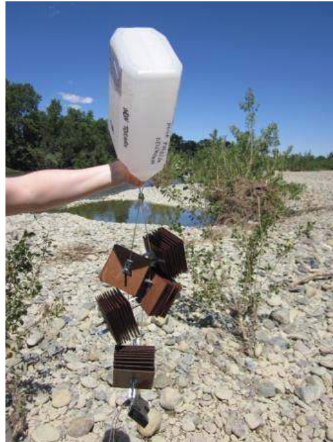
Figura 4.39. Substrati artificiali installati per la raccolta di macroinvertebrati bentonici. Sinistra: i substrati sono costituiti da lamelle di faesite grezza posti a diversa distanza; destra: gruppi di 5 substrati vengono legati e dotati di un galleggiante ad una estremità e da un peso all'altra.
