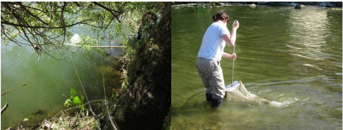
Figura 4.40. Tecniche di campionamento della fauna macrobentonica. Sinistra: gli organismi vengono raccolti mediante substrati artificiali, che vengono installati in situ mediante corde tiranti e bastoni distanziatori e lasciati in posto per circa un mese. Destra: campionamento mediante retino immanicato.
